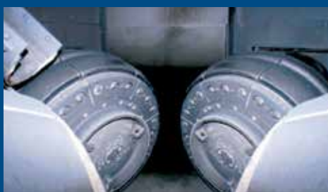
Vista de los rodillos en el interior de un molino OK™.
