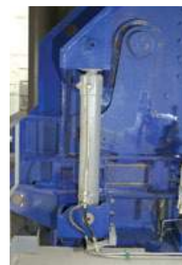
Гидроцилиндр для открытия верхней части дробилки
