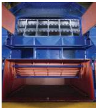
Отверстие для демонтажа отбойных плит и регулировки выходной решетки
